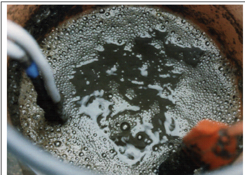
Photo 2: Blasenbild des Schlammes der KA Braunschweig bei einem
