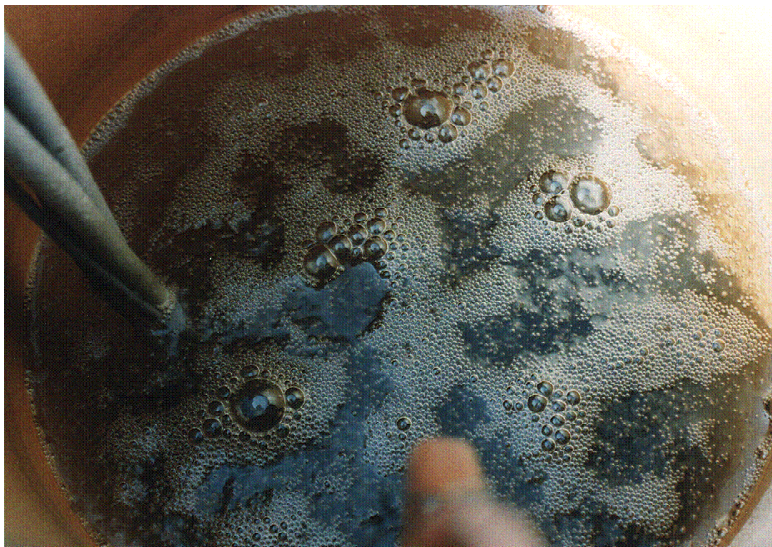
Photo 4: Blasenbild bei mit Salz versetztem Trinkwasser
